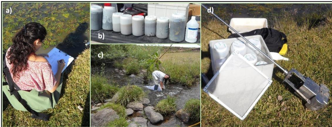
Fig. 3.1: a) Toma de datos en la planilla de campo; b) Recipientes plásticos rotulados con formaldehído al 4% para la fijación de los organismos; c) Muestreo en arroyos de las sierras bonaerenses con muestreador Surber; y d) Elementos de muestreo de arroyos pertenecientes a la Pampa Ondulada (cuadrado para vegetación, draga Ekman, frascos rotulados, bandeja).
