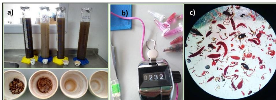
Fig. 3.2: a) Procesamiento del sedimento para realizar granulometría según el método húmedo de la pipeta de Folk. b) Cuenta-ganado para el conteo de los organismos más abundantes, tubos Eppendorf para el almacenamiento de macroinvertebrados, c) vista bajo microscopio estereoscópico de macroinvertebrados teñidos con eritrosina.
